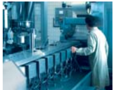
Extruder-Anlage zur lösemittelfreien Pflasterherstellung
